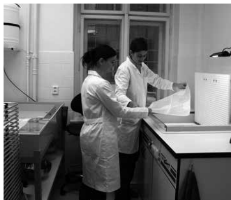
Mokrý provoz, dolévání papíroviny v dolévacím stroji na restaurátorském pracovišti v Praze-Braníku. (ABS)
