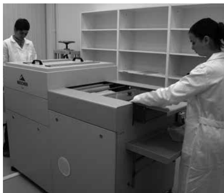
Přístroj Neschen C 500, proces hromadného odkyselování archiválií na restaurátorském pracovišti ABS v Praze-Braníku. (ABS)
